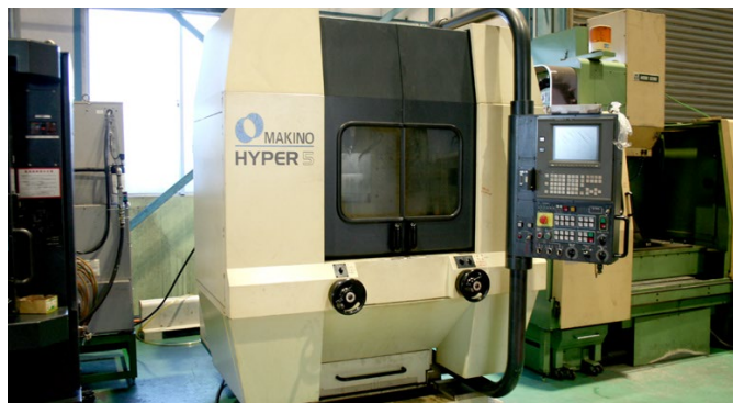
縦型MC(高速加工機) マキノ HYPER5 (1998)
