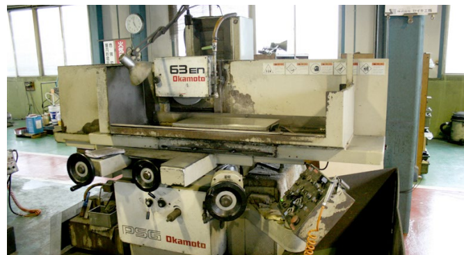
研磨機 岡本工作機械 PSG-63EN (1999.2)
